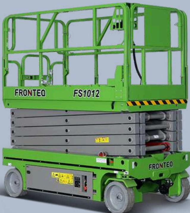
Equipada con batería AGM sin mantenimiento, un sistema de autodiagnóstico inteligente para una rápida resolución de problemas y bandejas de componentes abatibles, que requieren menos servicios programados y reducen en gran medida los costos de mantenimiento.
